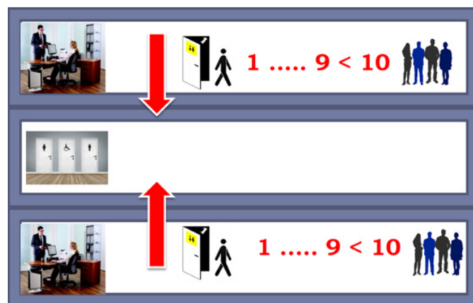
(Rys. 3) Zasady lokalizacji ustępów na kondygnacji w budynkach
