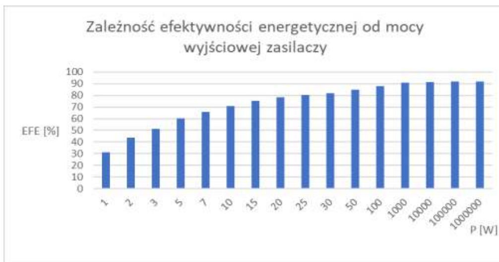
Rys. 4. Zależność efektywności energetycznej od mocy wyjściowej zasilacza (na podstawie [2])
