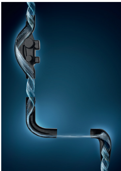
Fot. 4. Tworzenie i utrzymanie ciągłego słupa powietrza w systemie SuperTube
