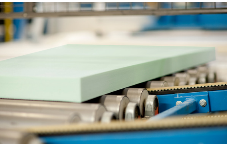
Fot. 3. Zamkniętokomórkowa płyta izolacyjna z pianki ArmaPet, pochodząca w 100% z recyklingu pokonsumpcyjnego
