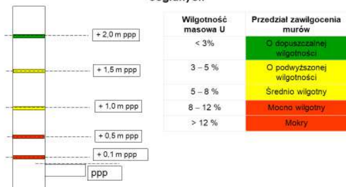
Pomiar wilgotności murów, przedziały zawilgoceń murów ceglanych
