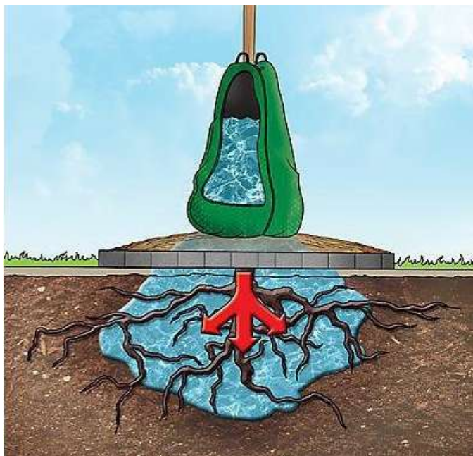
Rys. 2. Treegator (worek kroplujący), umieszczany na pniu sadzonego drzewa (schemat). Źródło: Zarząd Praskich Terenów Publicznych.
