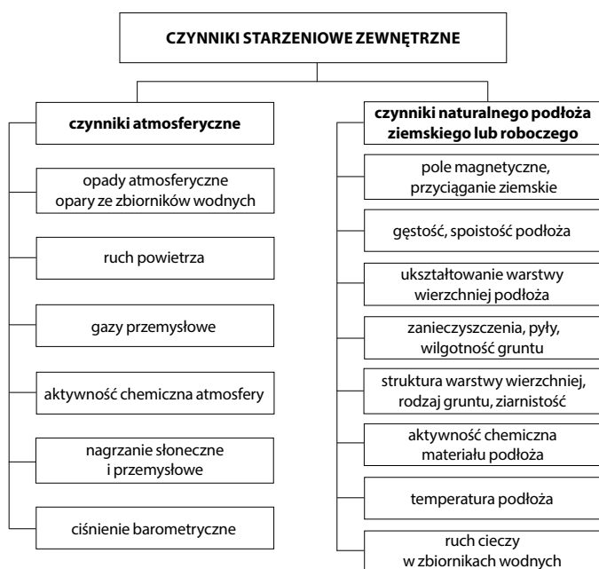
Rys. 1. Zewnętrzne czynniki starzeniowe elementów i konstrukcji budowlanych
